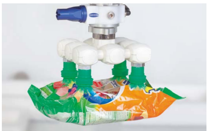
Effecteur de fin avec ventouses à soufflets SPB4f pour la manipulation de sachets d'emballage
