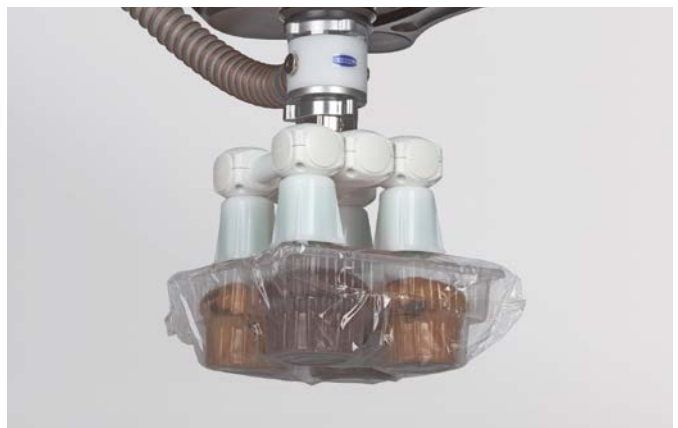
Effecteur de fin avec ventouses à soufflets SPB4 et éléments stabilisateurs pour la manipulation d'emballages plastiques instables
