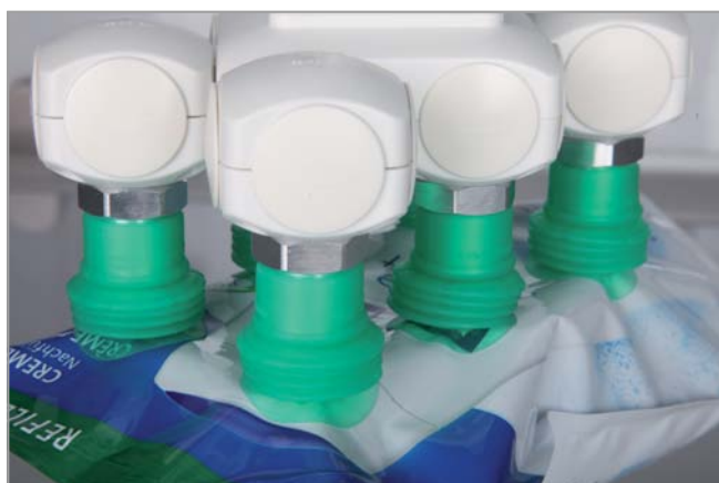
Ventouses à soufflets SPB4 lors de la manipulation de sachets et d'emballages souples
