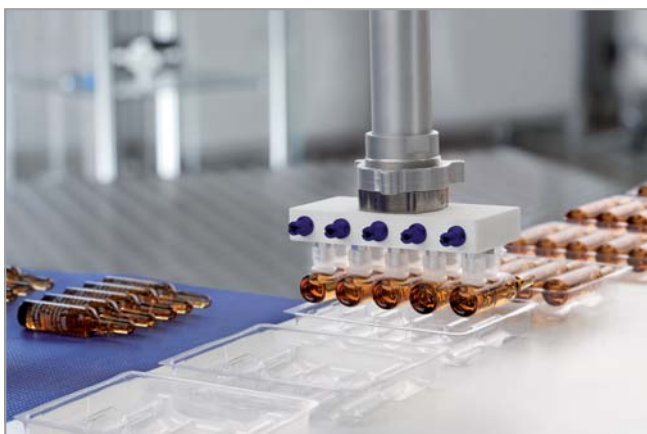
Génération du vide décentralisée par l'ecoPump SEP lors de la manipulation des ampoules
